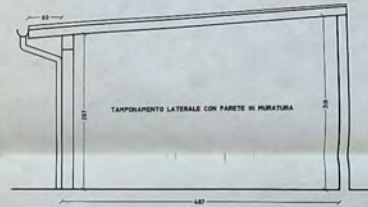
VISTA LATERALE TETTOIA - Scala 1:50
